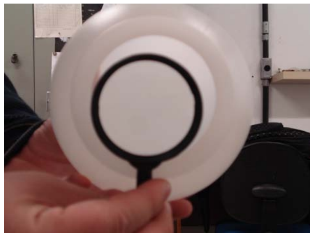
Figura 3.2 – Arranjo da lupa com o globo.
