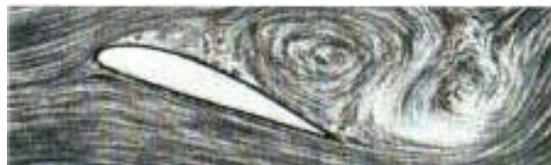
Figura 6 - Fluxo separado (estol) em volta do perfil (Fonte: DEWI).
